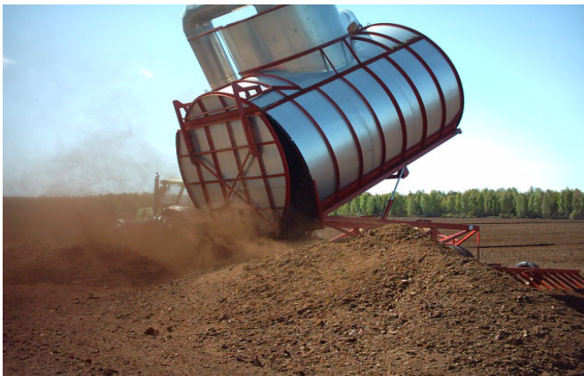
Häufeln des abgesaugten trockenen Torfes zum weiteren Abtransport
