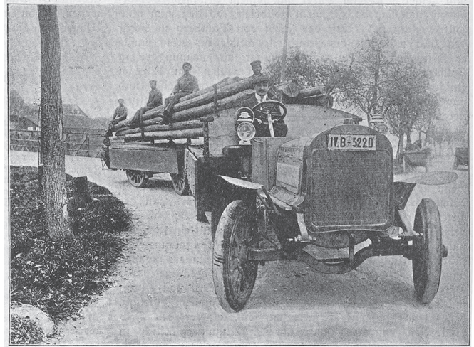
Lasterwagenzug, bestehend aus Lasterautomobil und Anhänger für 500—600 Kub Tragfähigkeit.
